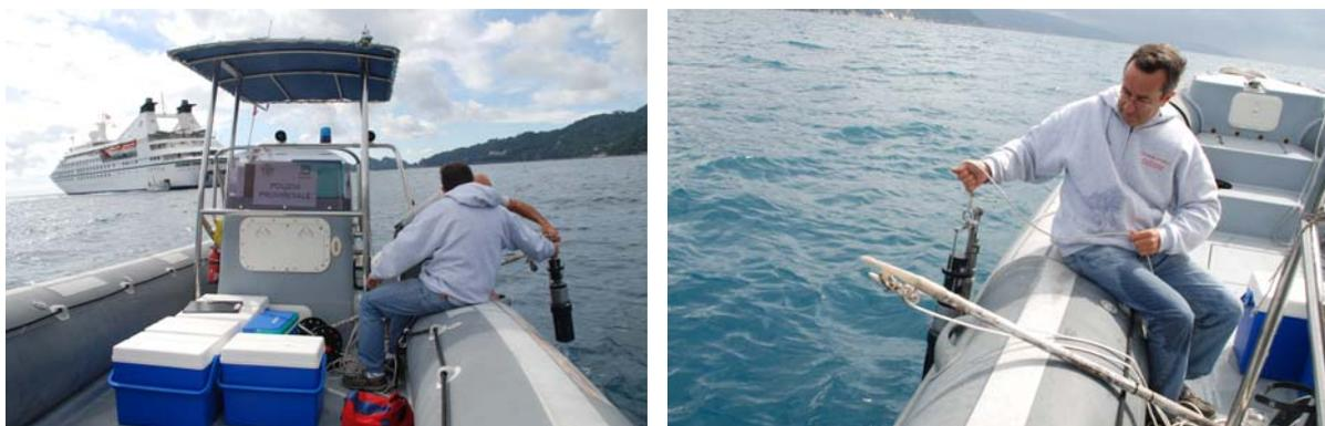
Figura 2: DISTAV, campionamento variabili oceanografiche con sonda multiparametrica
