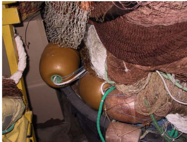
Figura 59 - Particolare di lima da sugheri della sciabica da natante
